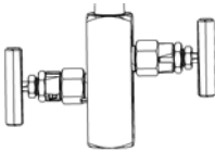
Integralni razvodnik Rosemount 306 (kôd modela S5)
