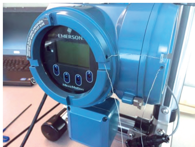
Рисунок 2. Механизм опломбирования и блокировки
